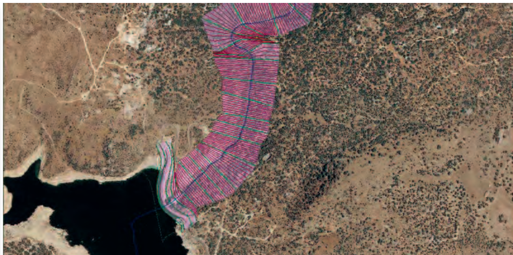
EN TONOS ROJIZOS Y MAGENTA, EL ENVOLVENTE DE INUNDACIÓN ESTIMADO EN EL CASO DE ROTURA TOTAL DEL MURO DEL EMBALSE. SIMULACIÓN MATEMÁTICA MEDIANTE PROGRAMA INFORMÁTICO HEC-RAS
