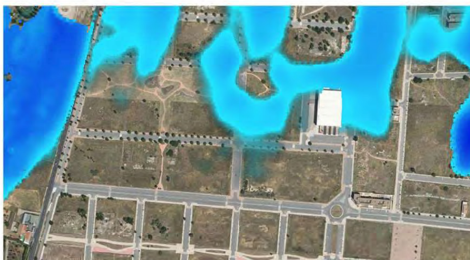
Peligrosidad por inundación fluvial para periodo de retorno de 100 años
